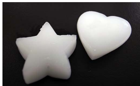
図3 キチンナノファイバー由来の結晶性ゲル
